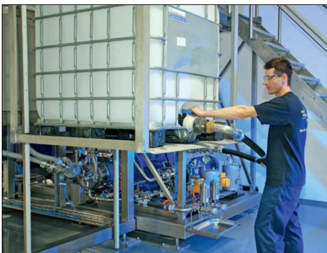
Abb. 6: Die tropffreie Flüssigkeitsdosierung
