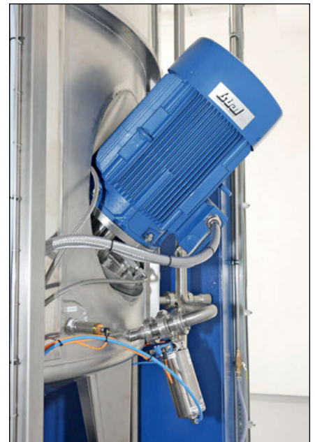
Abb. 5: Der integrierte Leitstrahlmischer
