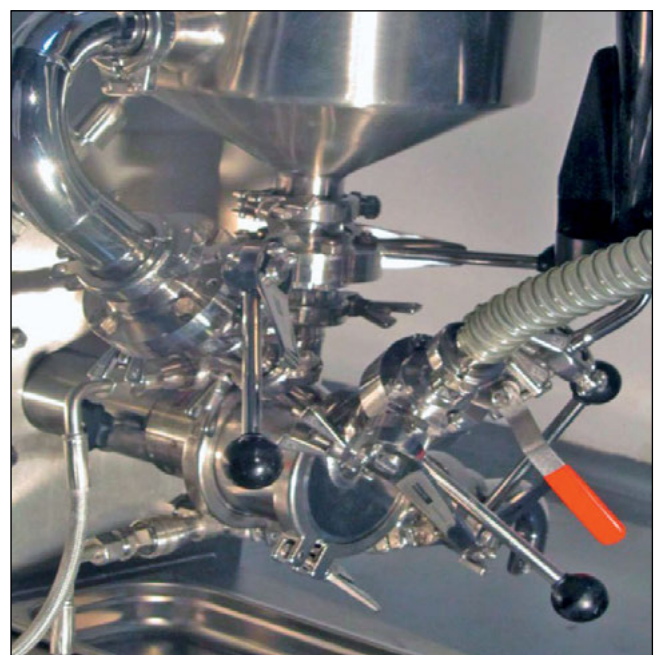
Abb. 4: Rohrleitungsweg von Mischbehälter über Mischkammer
